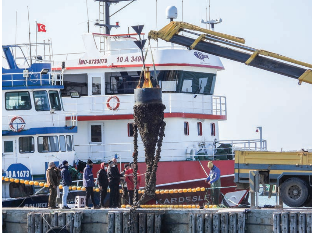
Şamandıra Cunda'da vinç ile sudan çıkarılırken The buoy is taken out of the water with a crane in Cunda
